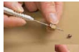
Rimuove setti, o-ring e ferrule senza danneggiare i fitting.
