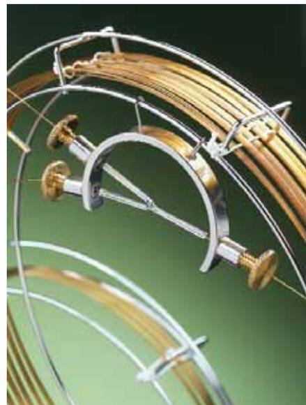
La geometria aperta dei connettori SeCure™ a “Y” e Vu2 Union™ permettono una conferma visiva della tenuta; il bloccaggio secondario previene scolleghamenti inattesi.
